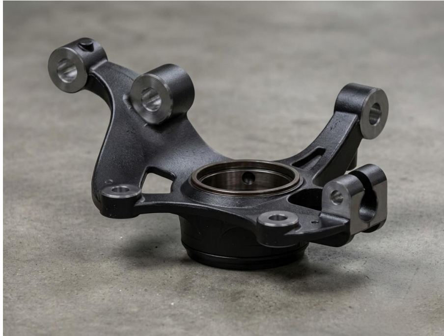
Imagen 163 - Renderizado Mangueta Rediseñada (Elaboración Propia)
