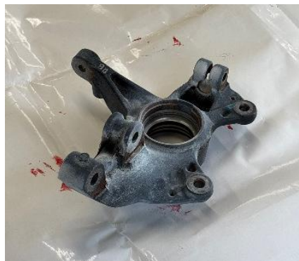
Imagen 45 - Acabado superficial: Preparación para al escaneo 3D (Elaboración Propia)
