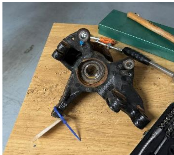
Imagen 41 - Rodamiento integrado a presión en la mangueta (Elaboración Propia)
