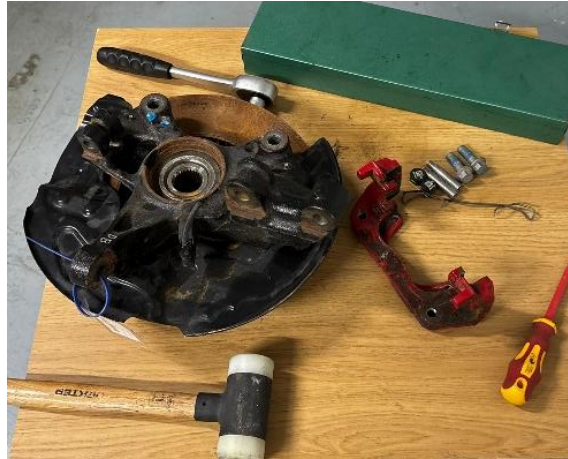
Imagen 35 - Portapinzas desacoplado de la mangueta (Elaboración Propia)
