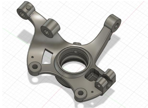
Imagen 160 - Vaciados Estructurales #1 - Modelado CAD Rediseño Mangueta (Elaboración Propia)
