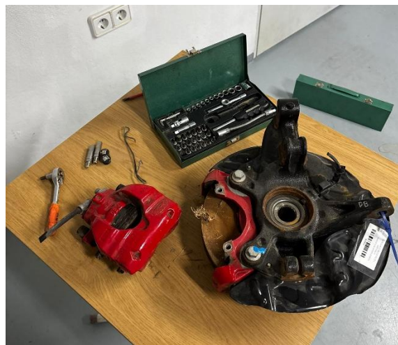
Imagen 34 - Pinza de Freno desacoplada del Soporte de Pinza (Elaboración Propia)
