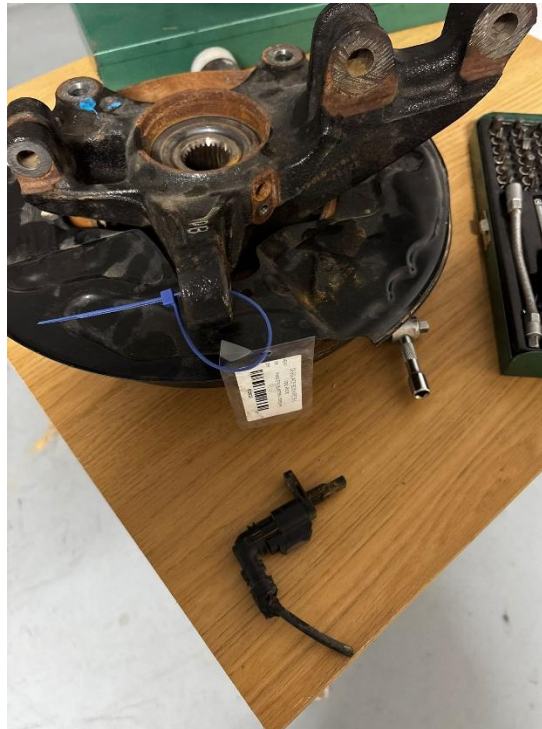
Imagen 37 - Sensor ABS desconectado de la mangueta (Elaboración Propia)
