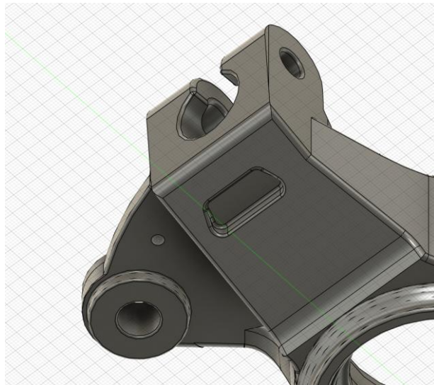
Imagen 93 - Modelado CAD – Vaciado Rótula Inferior (Elaboración Propia)
