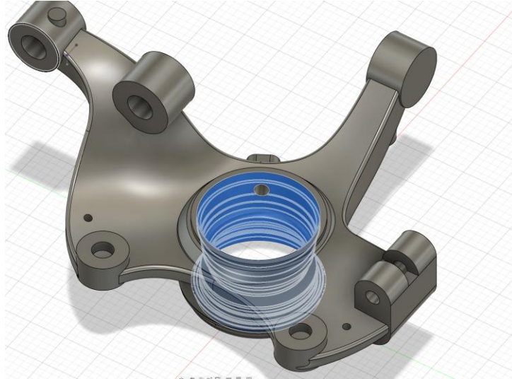
Imagen 159 - Revolución del Alojamiento del Rodamiento del Buje #1 - Modelado CAD Rediseño Mangueta (Elaboración Propia)
