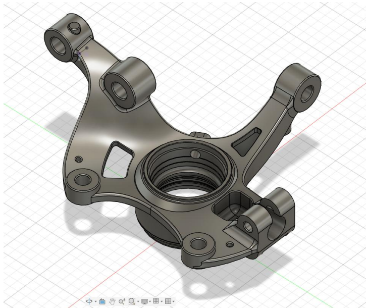
Imagen 162 - Resultado Final Modelado CAD - Modelado CAD Rediseño Mangueta (Elaboración Propia)
