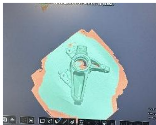
Imagen 49 - Nube de Puntos del Reverso de la Mangueta en EXScan (Elaboración Propia)
