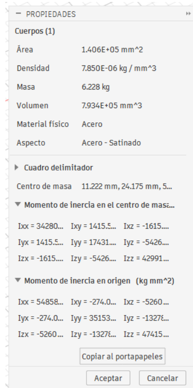
Imagen 97 - Propiedades del Modelado CAD Mangueta (Elaboración Propia)
