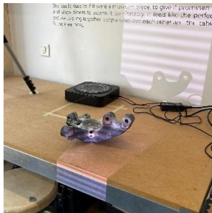
Imagen 47 - Proceso Manual de Escaneado de la Mangueta (Elaboración Propia)
