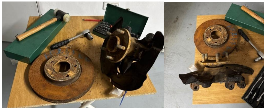
Imagen 38 - Disco de Freno extraído del conjunto de la mangueta (Elaboración Propia)
