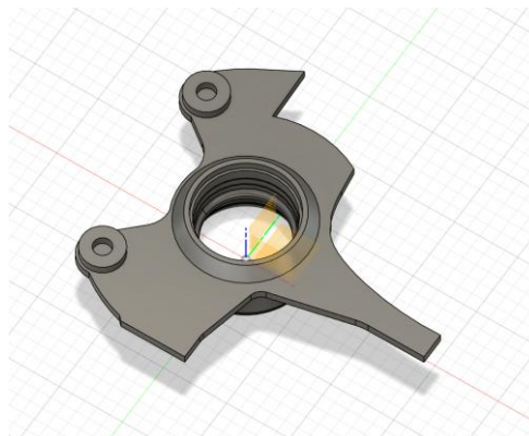
Imagen 67 - Modelado CAD – Extrusión Geometría de Soporte (Elaboración Propia)
