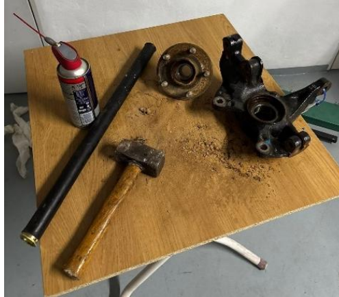
Imagen 40 - Buje extraído de la mangueta (Elaboración Propia)
