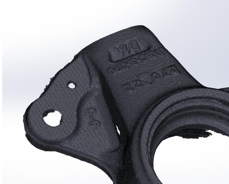
Imagen 56 - Muestra de la Densidad de la Malla tras el Escaneado 3D (Elaboración Propia)
