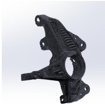
Imagen 53 - Malla Anverso de la Mangueta (Vista de Perfil) (Elaboración Propia)
