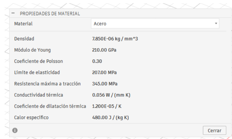
Imagen 115 - Propiedades del Acero (Material Mangueta Original) (Elaboración Propia)
