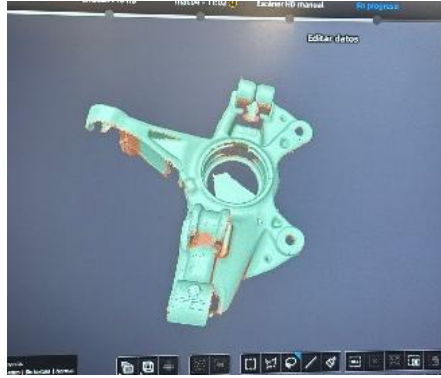
Imagen 50 - Nube de Puntos del Anverso de la Mangueta en EXScan (Elaboración Propia)
