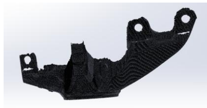
Imagen 55 - Malla Reverso de la Mangueta (Vista de Perfil) (Elaboración Propia)
