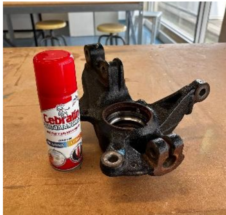
Imagen 44- Acondicionamiento superficial previo al escaneo 3D (Elaboración Propia)
