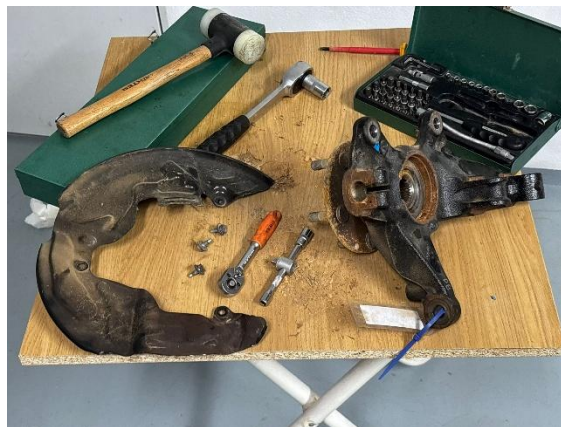
Imagen 39 - Extracción Chapa Protectora del Disco de Freno (Elaboración Propia)
