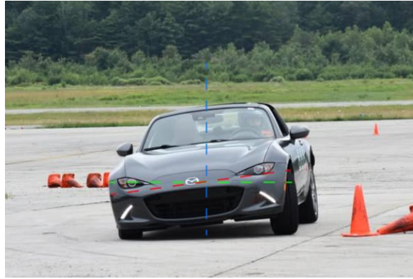
Imagen 102 - Mazda MX-5 Miata Transferencia de Pesos en Giro
