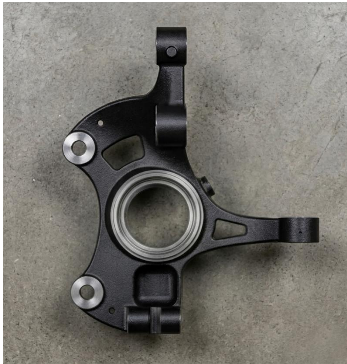
Imagen 165 - Renderizado Mangueta Planta (Elaboración Propia)
