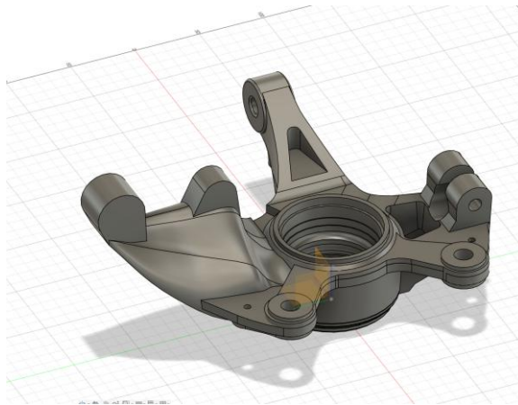
Imagen 83 - Modelado CAD – Anclajes del Brazo de Suspensión (Elaboración Propia)
